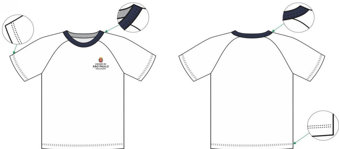
Figura 02 – Ilustração dos detalhes de costuras em diferentes pontos da peça
