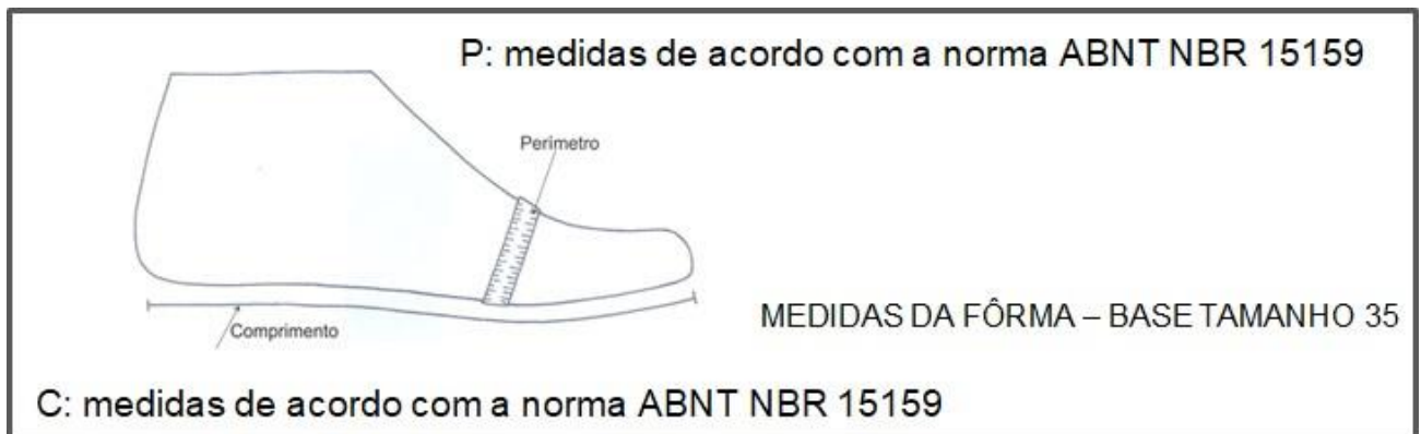
Figura 3 – Medidas da Fôrma
